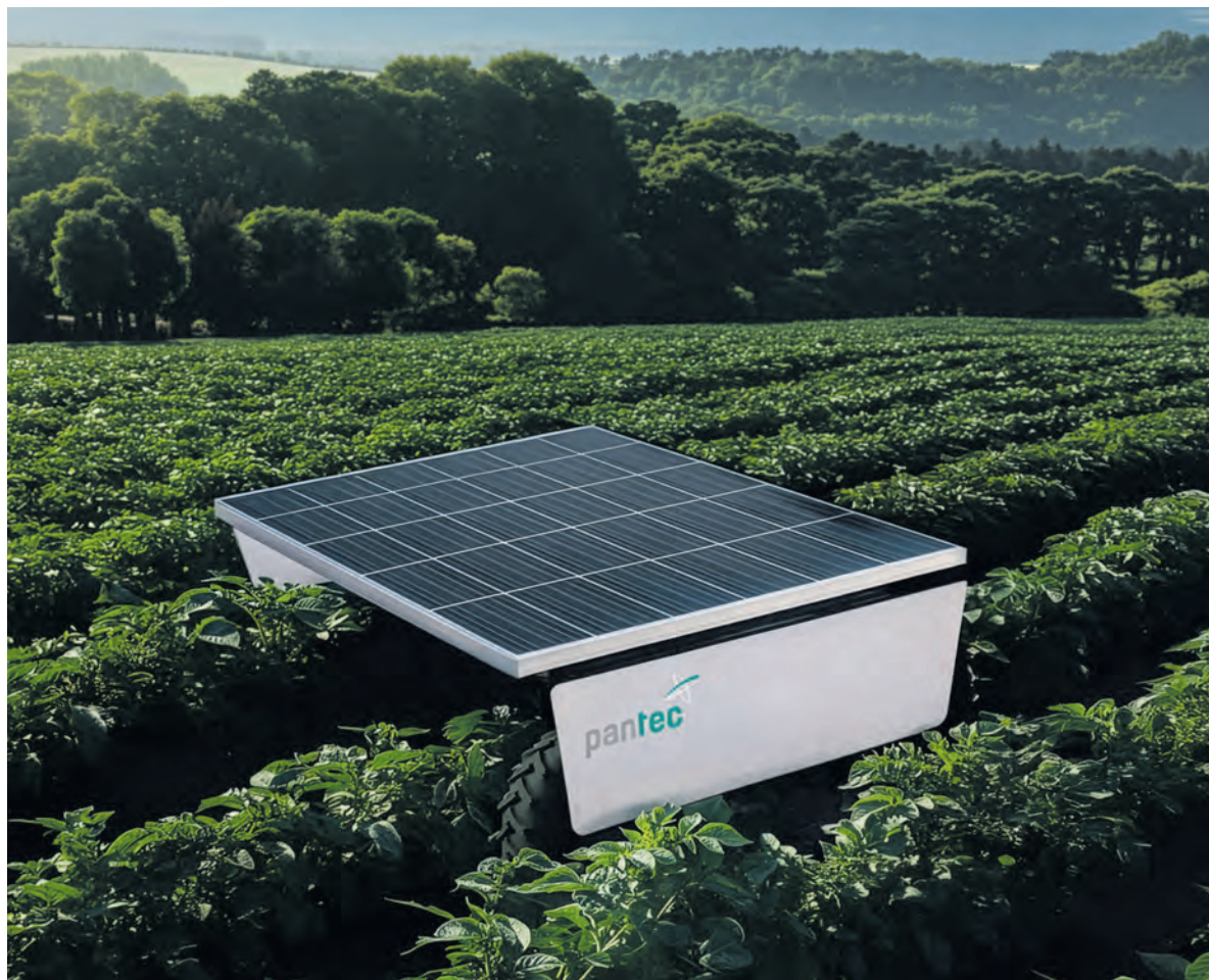
LaserFly ist ein autonomes, laserbasiertes System für die Landwirtschaft. Es wurde von Pantec Biosolutions speziell für eine nachhaltige Schädlings- und Unkrautbekämpfung entwickelt.
